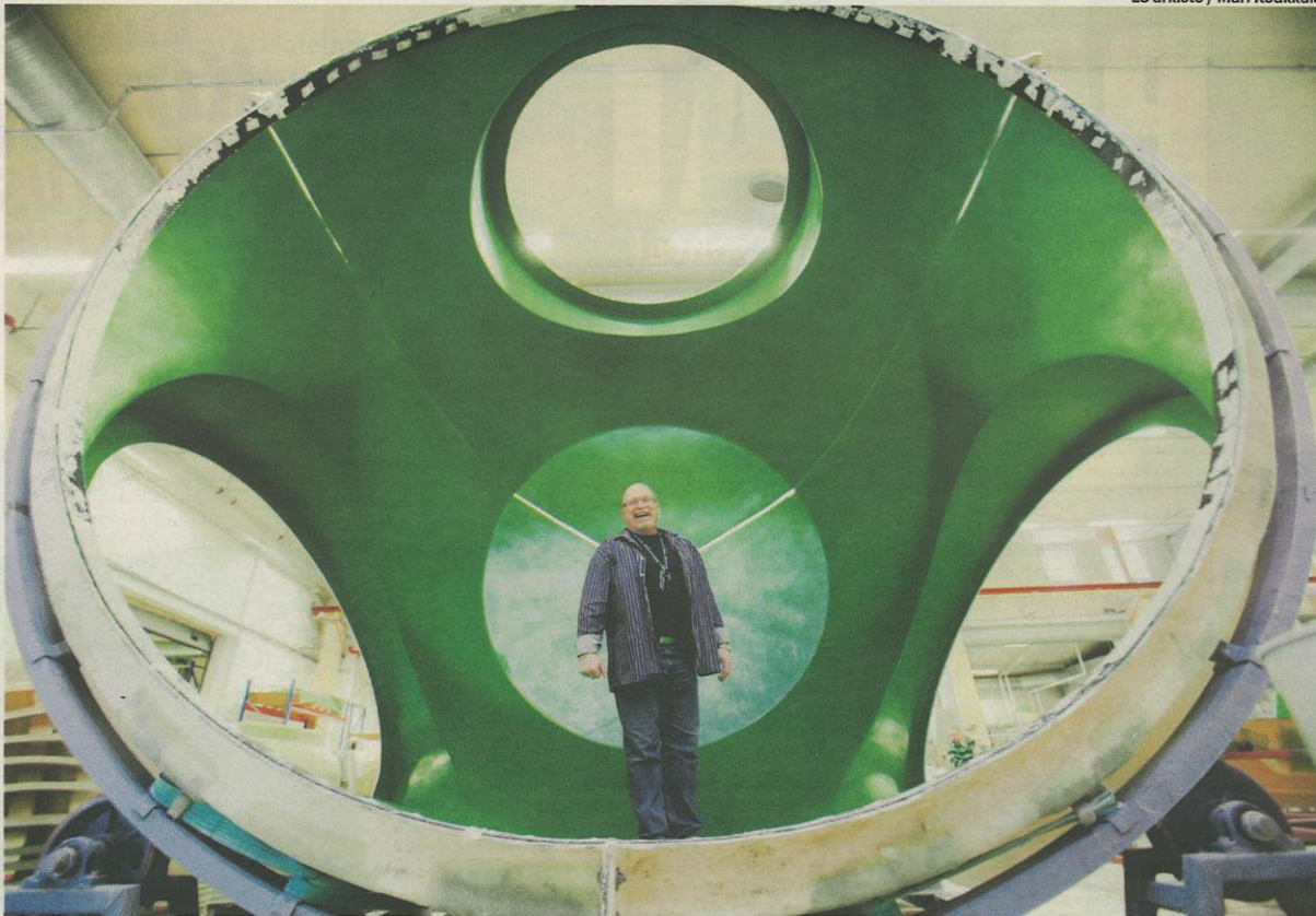
Tuulivoimala on iso. Erkki Lappi perheyrikykset valmistavat lujitemuovista tehtyjä suojarakenteita tuulivoimaloihin. Lappi seisoo tuulivoimalan roottorin navan suojakuvussa.
