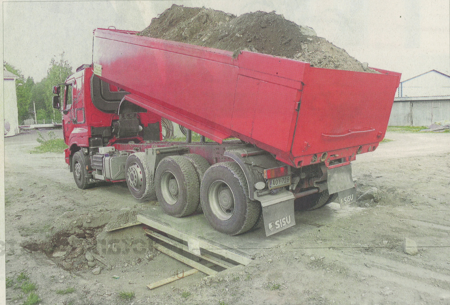
Lujitemuovinen siltapala kesti sorakuormassa olevan kuorma-auton painon, yli 30 tonnin painolastin, Ekin Muovin omassa kokeessa.
